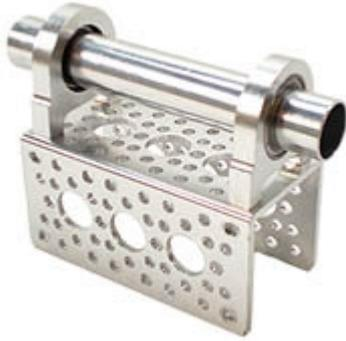
Cuscinetto con supporto in alluminio per montaggio verticale. Dispone di due fori filettati da 3 mm per il fissaggio. Diametro interno cuscinetto: 15,87 mm, dimensioni supporto (mm): 33,90 (altezza) x 32,95 (larghezza) x 6,35 (spessore). La confezione comprende 1 cuscinetto su supporto.
