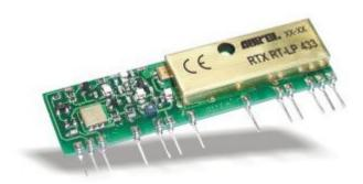
Ricetrasmettitore con micro assorbimento e minima tensione di alimentazione ideale per sistemi radio RX-TX half-duplex con RX sempre alimentato e ritardo alla risposta nullo. Utilizzabile con: AM OOK 433.92. Alimentazione: 3 V, Consumo: 80 μA, Frequenza: 433.92 MHz, Sensibilità: -95 dBm, Bit rate: 2400 bps, Dimensioni: 63.3x17.2x5 mm. (Codice Aurel: RTX-RTLP-434, 650200589).
