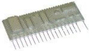
Decodifica a 4 canali con uscite monostabili o a latch, complemento di tutti i ricevitori dati AUREL e dei trasmettitori a 4 canali con encoder HT12E. Ideale per applicazioni in cui è richiesto più di un comando codificato. Utilizzabile con trasmettitori palmari con Encoder HT12E. Alimentazione: +5÷15 V, Consumo: 1 mA (stand-by), Encoder: HT12E, Decoder: HT12D, Codici: 1024, Dimensioni: 51.2x18.4x4.3 mm (Codice Aurel: D4ML,650200450).
