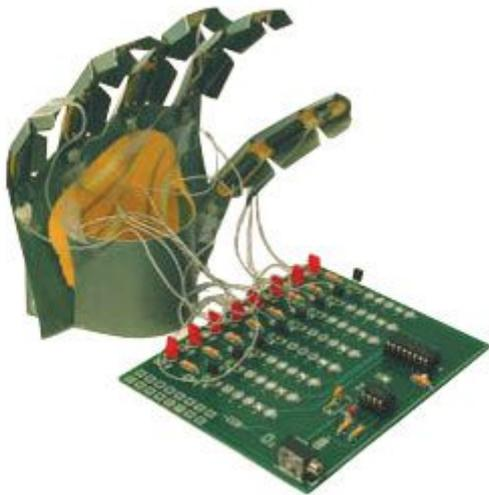
Modello di mano in mylar che, si muove in modo completamente silenzioso e realistico, grazie a 5 fili di Flexinol e ad un circuito di controllo.
