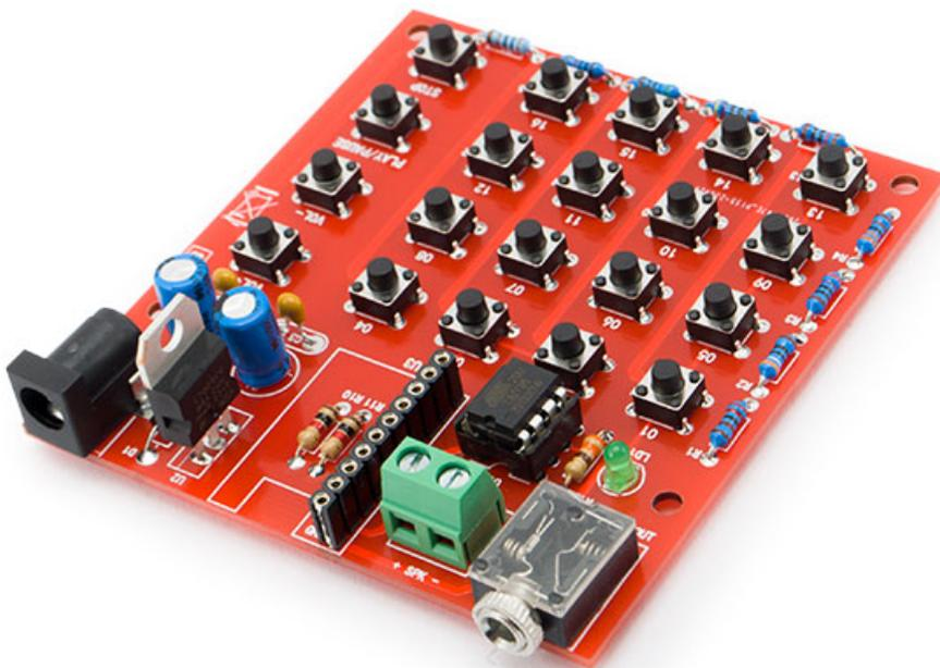
La demoboard FT1700K montata. Il modulo MP3 ( MP3PLAYERUSB ) va acquistato separatamente.[/caption]
