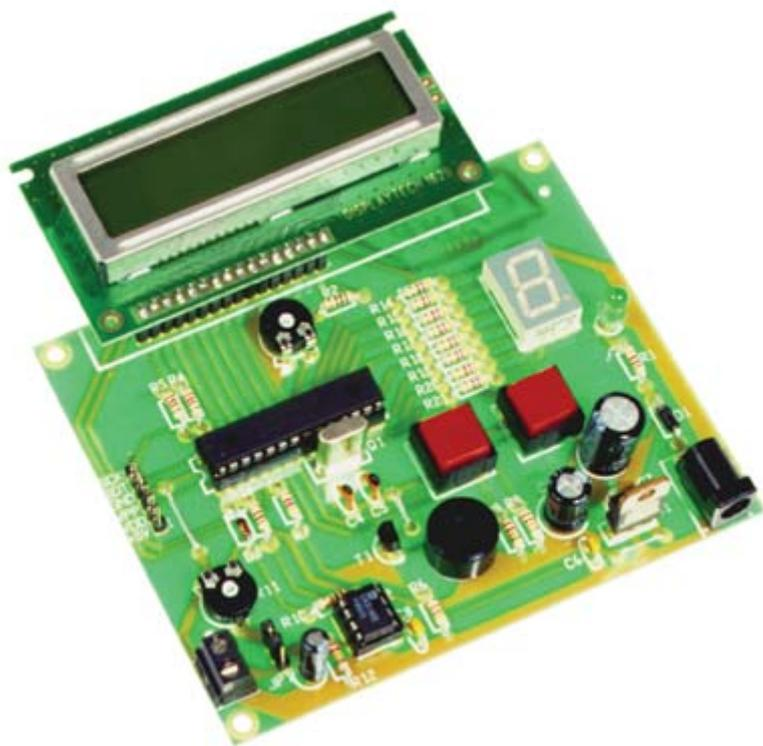
Demoboard grazie alla quale è possibile implementare, tramite il PIC16F876A l'utilizzo di un display LCD 16x2 caratteri, un display a 7-segmenti, due pulsanti, un cicalino e l'acquisizione di grandezze analogiche; il tutto con la possibilità di sfruttare la programmazione in-circuit del micro. Il kit comprende tutti i componenti, la basetta forata e serigrafata, il display LCD, il microcontrollore PIC16F876A e un dischetto con i programmi dimostrativi in linguaggio Assembler e in Basic.
