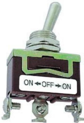
Deviatore di potenza a levetta (momentaneo) in grado di attivare carichi con assorbimento massimo di 10 A a 250 V. Tipo: SPDT (Singolo polo doppio contatto). Spostando la levetta verso uno dei due contatti laterali, non appena viene rilasciata, la levetta torna in posizione centrale. Dimensioni 33x20x57,7 mm. Diametro foro di fissaggio: 12,2 mm. Terminali con morsetto a vite.
