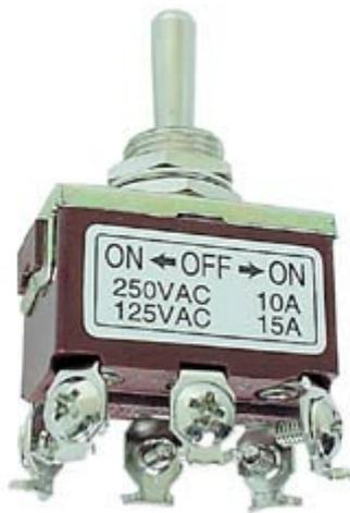
Doppio deviatore di potenza a levetta (momentaneo) in grado di attivare carichi con assorbimento massimo di 10 A a 250 V. Tipo: DPDT (Doppio polo doppio contatto). Spostando la levetta verso uno dei due contatti laterali, non appena viene rilasciata, la levetta torna in posizione centrale. Dimensioni 33x20x57,7 mm. Diametro foro di fissaggio: 12,2 mm. Terminali con morsetto a vite.
