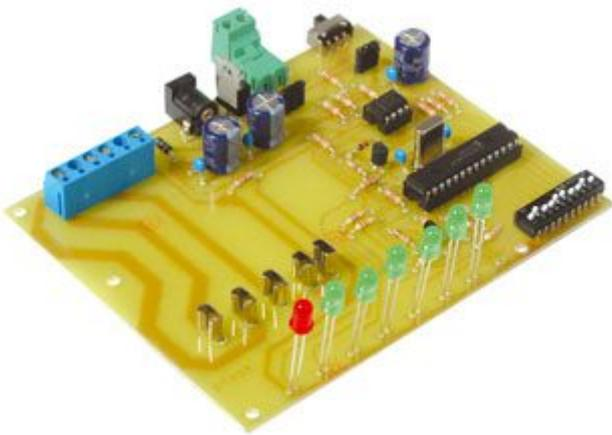
Dimmer controllabile tramite protocollo DMX. Disporre di un'alimentazione di 12V DC per il collegamento ai sistemi di potenza ma può anche operare in apposito modulo per il controllo diretto di carichi alimentati dalla tensione di rete. Disporre di una batteria a led che indica il valore attuale dell'uscita. L'induttore può essere anche facilmente fornito da switch in 12V che il protocollo DMX prevede.
