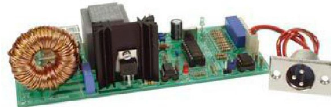
Il dimmer DMX a 1 canale in scatola di montaggio è l'ideale per controllare una o più lampade con un segnale DMX, garantendo un controllo centralizzato delle luci in teatri, discoteche e in tutti gli ambienti in cui è richiesta una gestione accurata delle luci. Questo dimmer è compatibile con tutte le apparecchiature che funzionano con lo standard DMX-512, garantendo una facile integrazione con i sistemi esistenti. Grazie alla sua alta qualità e alla facile installazione, il dimmer DMX a 1
