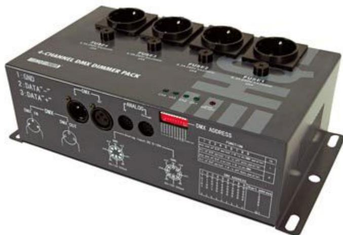
Dimmer 4 canali per segnali in ingresso tipo DMX o analogico - carico massimo per canale 5 A - le prese sono del tipo SHUKO e protette da relativo fusibile.
