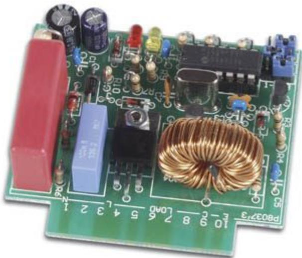
Dimmer da utilizzare in abbinamento al kit K8006. Consente di variare la luminosità delle lampade collegate. Dispone di funzioni di sicurezza per incrementare la durata delle lampade tra le quali la tecnologia "Soft-Start" e di auto disattivazione in caso di intensità luminosa insufficiente.
