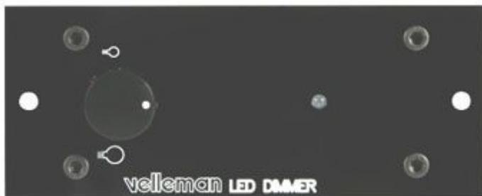
Permette di controllare l'accensione di strip a LED RGB da 12 e 24V, strip a LED singolo colore da 12 e 24V, lampade alogene a 12V, lampade ad incandescenza e lampade a LED a 12 V. Dispone di manopola per la regolazione della luminosità. Montaggio ad incasso. Alimentazione: da 12 a 24 Vdc, uscita: 5 A, dimensioni: 100 x 40 x 35 mm.
