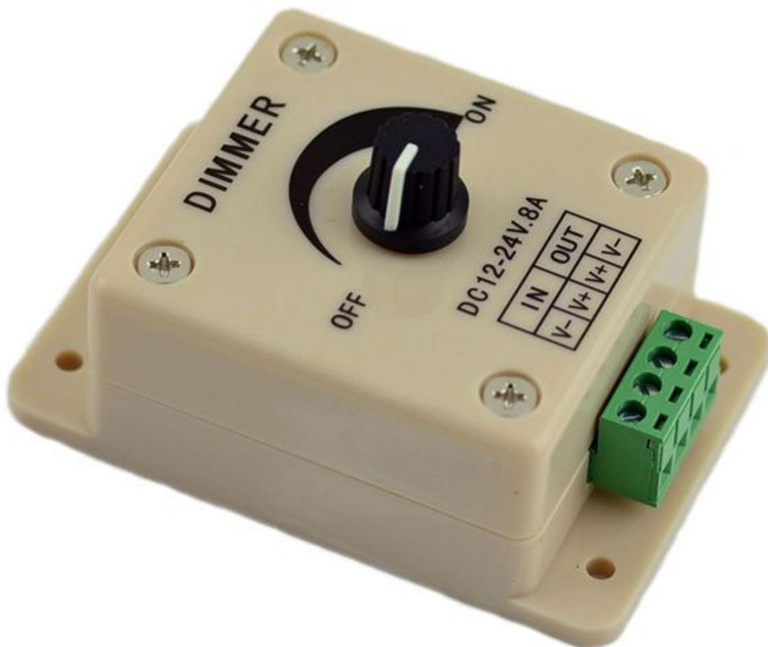
Dimmer per strip LED a singolo colore, lampade a LED, tubi a LED con alimentazione da 12 a 24 VDC e corrente massima di 8 A. Regola la luminosità in modo stabile e senza sfarfallio da 0 al 100%. Una morsettiera a vite consente di effettuare i collegamenti, per l'alimentazione e per il carico, in modo semplice e rapido. Dimensioni (mm): 89x60x50, temperatura di funzionamento: da -20°C a + 60°C.
