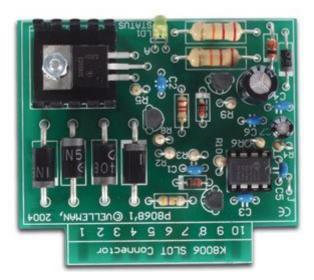
Dimmer per il kit K8006 utilizzabile con un trasformatore elettronico.
