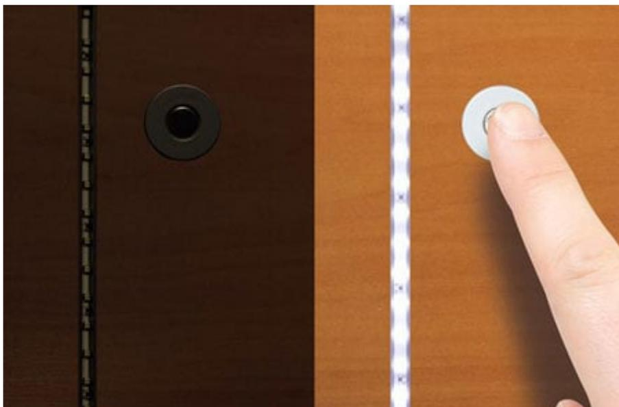
Dimmer touch per strip a LED a singolo colore. Con un tocco breve accende e spegne la strip, mentre con un tocco prolungato aumenta e diminuisce la luminosità. Alimentazione: 12 V / 24 W, carico massimo: 2 A, frequenza PWM: 770 Hz, dimensioni: Ø 22 x 16 mm, diametro foro di montaggio: 16 mm, peso: 20 grammi. **Attenzione!** la corrente di uscita dell'alimentazione non deve essere superiore a 2 A.
