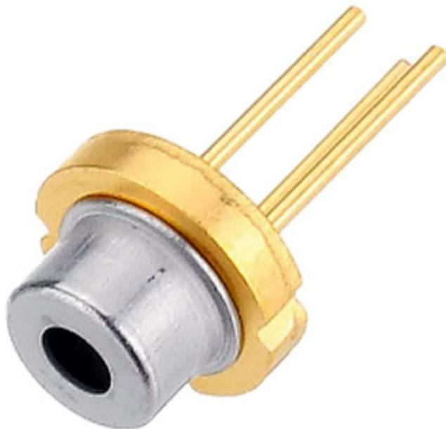
Diodo LASER da 5 mW con emissione a 650 nanometri, alimentazione compresa tra 2,1 e 2,5 VDC, consumo: max 25 mA e Case: TO-18. Particolarmente indicato per essere impiegato in scanner, lettori di codici a barre, sensori, ecc.
