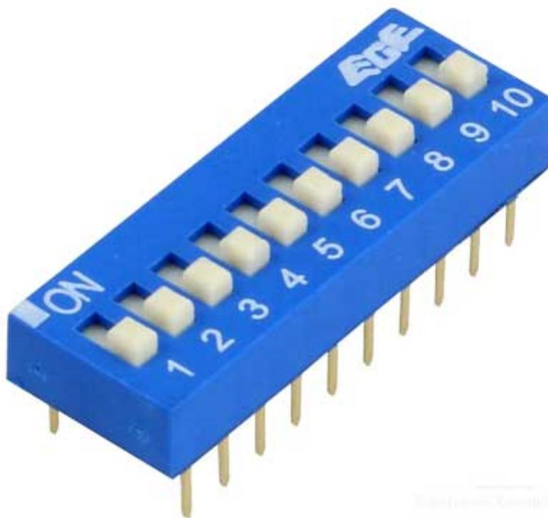
Dip switch da circuito stampato, 10 posizioni, 20 pin, passo 2,54 mm.
