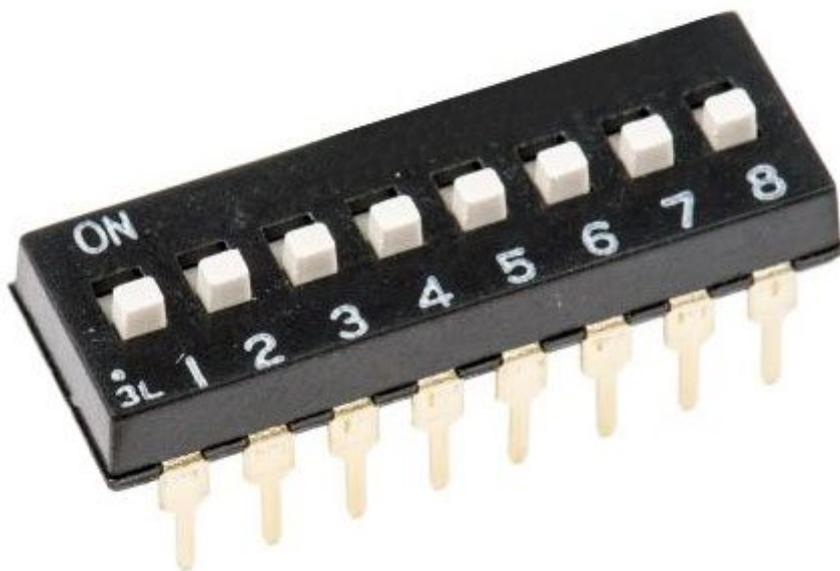
Dip switch da circuito stampato, 6 posizioni, 16 pin, passo 2,54 mm.
