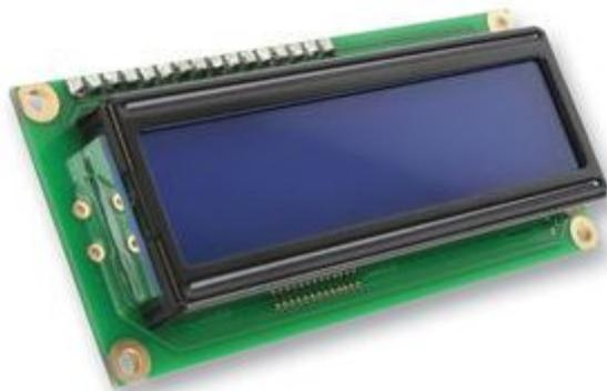
Display LCD monocromatico 16 caratteri su 2 righe, retroilluminazione blu, interfaccia parallela standard a 8 bit, connettore femmina già saldato, alimentazione 5 Vdc. Utilizzato con la scheda di sviluppo per PIC EASYPICV7. Dimensioni (mm): 75,2x31,2x13,5, peso: 36 grammi.
