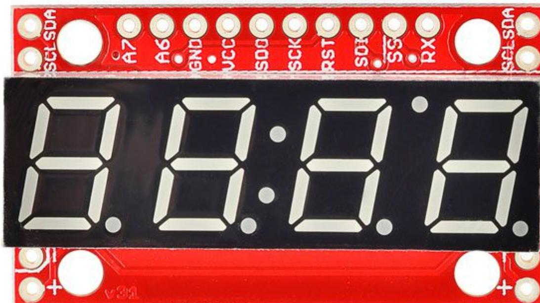
Modulo composto da un classico display a 7 segmenti a 4 cifre e da un microcontrollore ATmega328 con bootloader Arduino. Può essere controllato in tre modi: comunicazione seriale TTL, SPI o I<sup>2</sup>C. Visualizza numeri, molte lettere e alcuni caratteri speciali. Sono presenti anche le piazzole FTDI per la programmazione tramite l'IDE Arduino.
