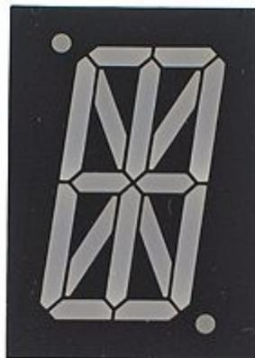
Display alfanumerico (16 segmenti) a LED rosso con anodo comune. Intensità luminosa 20-25 mcd, basso consumo, alimentazione 3,2 Vdc, altezza digit (mm): 25,4, dimensioni esterne display (mm): 33x23x9.
