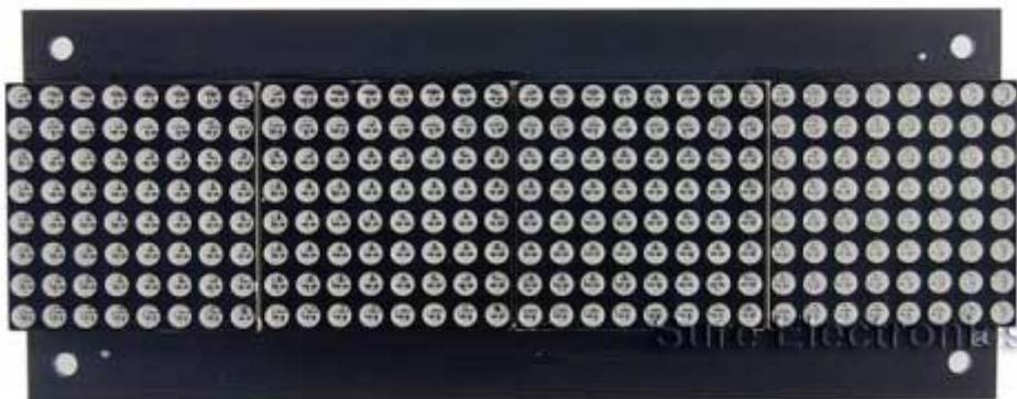
Display a matrice composto da 4 cifre formate da 64 LED rossi (da 3 mm) ciascuna e basato sul controller HT1632C della Holtek. Può visualizzare lettere, cifre o simboli e dispone di 10 livelli di controllo della luminosità. Possono essere collegate in serie fino a 4 schede. Alimentazione: 12 Vdc, dimensioni PCB (mm): 128x60x23,84, dimensioni 4 display (mm): 128x32,25. La confezione comprende il display a matrice e cavo IDC a 10 pin.
