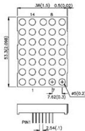
Display costituito da 35 LED rossi ad alta efficienza. Colonna catodo comune. Intensità luminosa ( $I_f = 10\text{mA}$ ): 5600-14000  $\mu\text{cd}$ . Lunghezza d'onda: 660 nm. Altezza cifre: 50 mm. Dimensioni: 38 x 53,3 mm. Utilizzato nel progetto "Orologio Binario" pubblicato su [Elettronica In n. 133 Dicembre2008/Gennaio2009](#).
