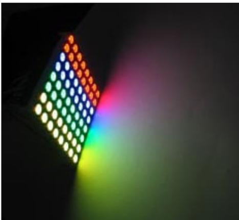
Display costituito da 64 LED RGB ad alta efficienza. Colonna catodo comune. Intensità luminosa ( $I_f = 20\text{mA}$ ): rosso 130 mcd, verde 270 mcd e blu 70 mcd. Dimensioni: 60,5 x 60,5 mm. Può essere controllato con la scheda 7300-RAIMBOWDUINO.
