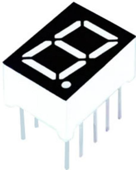
Display 7 segmenti ad catodo comune. Dimensioni 10x13mm. Tensione nominale: da 1,6V a 2,8V, temperatura di lavoro: da -30°C +85°C, potenza max. 60mW, dimensioni: 10 x 13 x 7mm.
