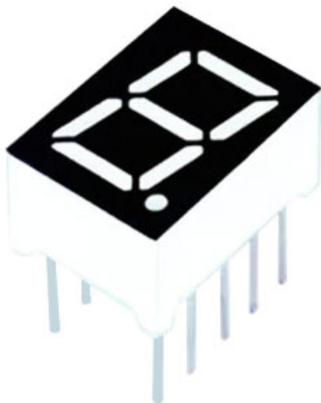
Display 7 segmenti ad catodo comune. Dimensioni 10x13mm. Tensione nominale: da 1,6V a 2,8V, temperatura di lavoro: da -30°C +85°C, potenza max. 60mW, dimensioni: 10 x 13 x 7mm.
