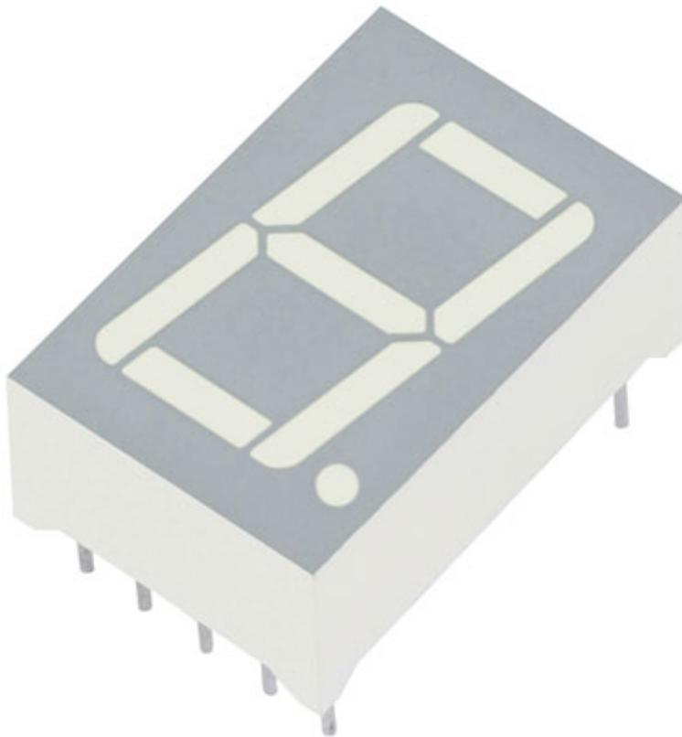
Display catodo comune verde. Tensione nominale: da 1,6V a 2,8V, temperatura di lavoro: da -30°C a +85°C, potenza: 60 mW, dimensioni: 12,4 x 17,5 x 7mm. Altezza del carattere 0,52? ( 13,2 mm ) spaziatura pin 2,54 mm
