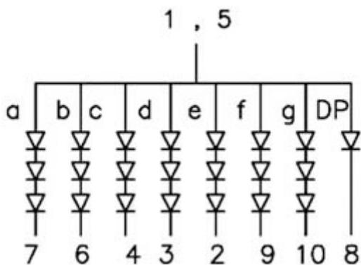
Display digitale 45mm a led super rosso con anodo comune. Specifiche: materiale: super-rosso GaAsP/GaP, lunghezza d'onda: 625nm, intensità luminosa ( $I_f = 10\text{mA}$ ): 3600 - 21000 $\mu\text{cd}$ .
