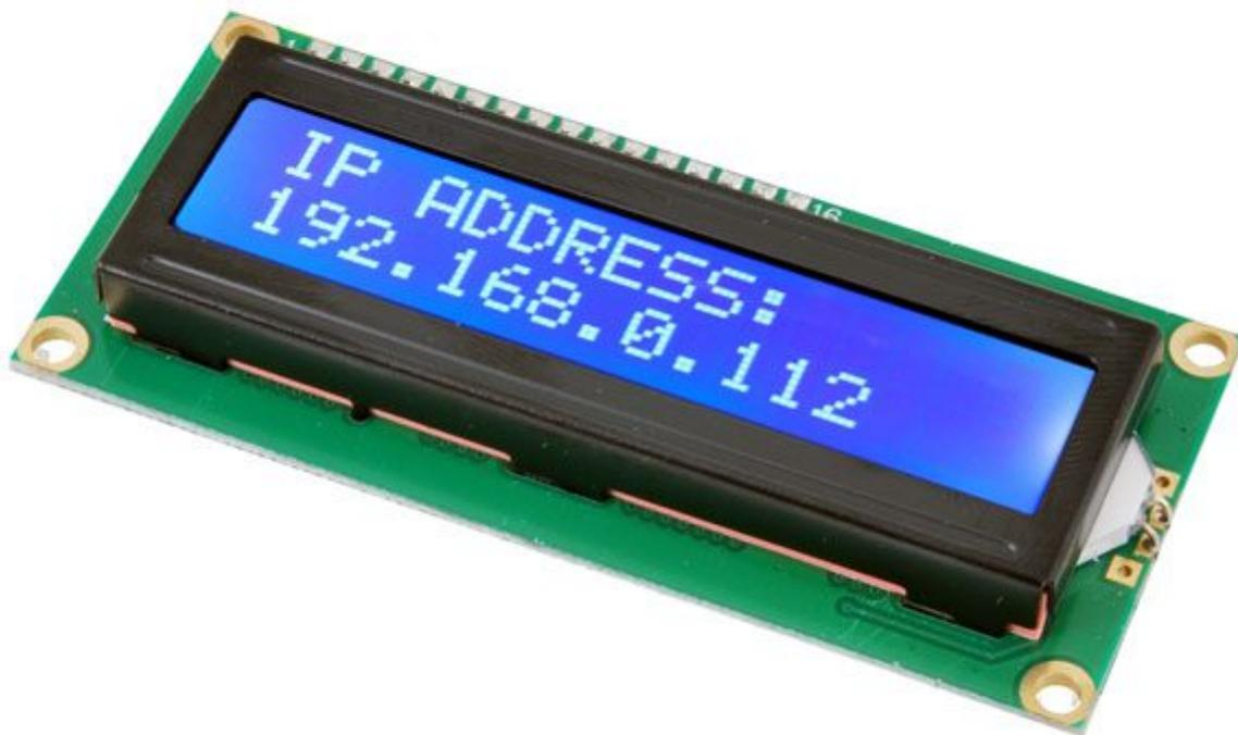
Display LCD con connettore strip già saldato. Dispone di 2 righe e 16 caratteri alfanumerici bianchi con retroilluminazione blu. Utilizza il controller HD44780 ([datasheet](#)). Alimentazione: 5 Vdc. Dimensioni (mm): 80x36x11.
