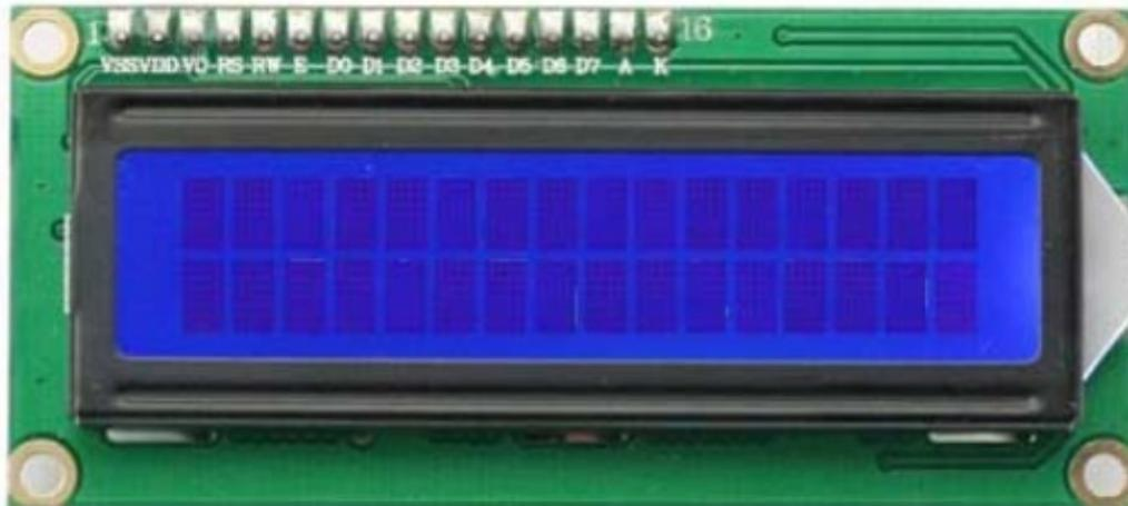
Display LCD 2 righe e 16 caratteri alfanumerici con controller HD44780, retroilluminazione blu, caratteri bianchi e interfaccia I<sup>2</sup>C. Particolarmente indicato per ridurre il numero di I/O richiesti in caso di utilizzo con Arduino o altro microcontrollore, l'interfaccia I<sup>2</sup>C dispone di jumper per attivare la retroilluminazione e regolazione del contrasto che viene effettuata tramite un piccolo trimmer. Alimentazione: 2,5-6 Vdc, dimensioni (mm): 80x36x19, peso: 100 grammi.
