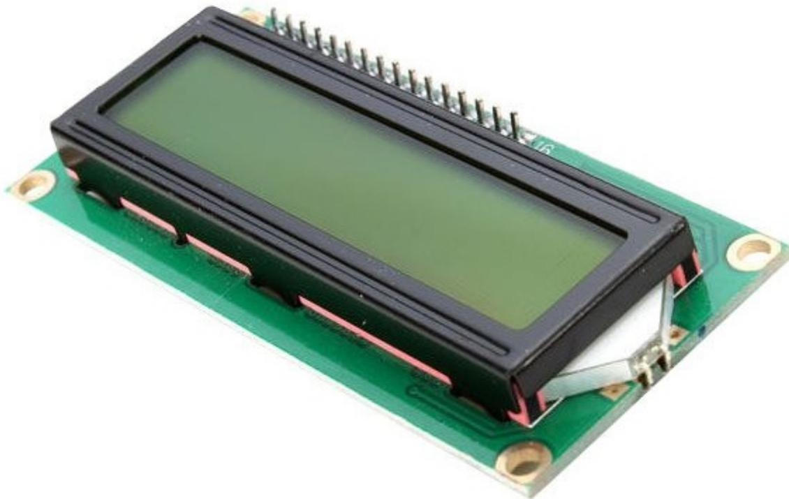
Display LCD con connettore strip già saldato. Dispone di 2 righe e 16 caratteri alfanumerici neri con retroilluminazione verde. Utilizza il controller HD44780 ([datasheet](#)). Alimentazione: 5 Vdc. Dimensioni (mm): 80x36x11.
