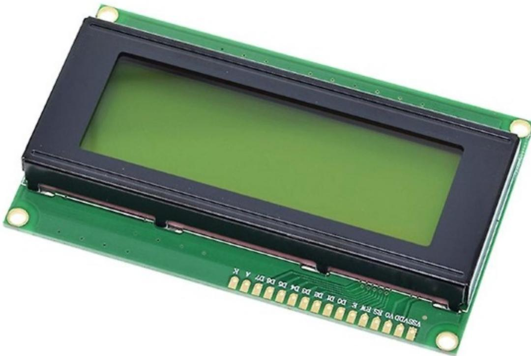
Display LCD 4 righe a 20 caratteri con retroilluminazione verde e caratteri alfanumerici neri. Utilizza il controller HD44780 ([datasheet](#)). Alimentazione: 5 Vdc. Dimensioni: 98 x 60 x 14 mm.
