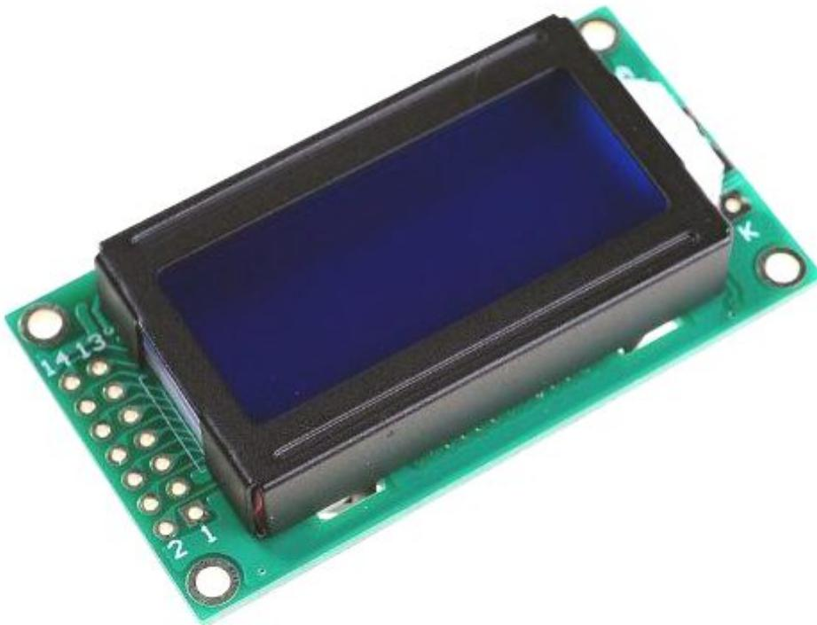
Display LCD 8x2 (8 caratteri - 2 righe) con retroilluminazione blu e caratteri bianchi. Utilizza il controller grafico SPLC780D. Si può utilizzare con la libreria Arduino LCD ([clicca qui per scaricare](#)). Dimensioni (mm): 58x32x13. Alimentazione: da 3,3 Vdc a 5 Vdc, temperatura di lavoro: da -20°C a +70°C.
