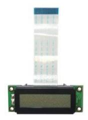
Display LCD con retroilluminazione a led bianchi, 2 righe e 16 caratteri alfanumerici. Alimentazione: 5 Vdc. Dimensioni area di visualizzazione:  $80 \times 36 \times 8,40$  mm, dimensione carattere:  $3,15 \times 1,85$  mm. Temperatura di funzionamento: da 0°C a + 50°C. Peso: 13 grammi.
