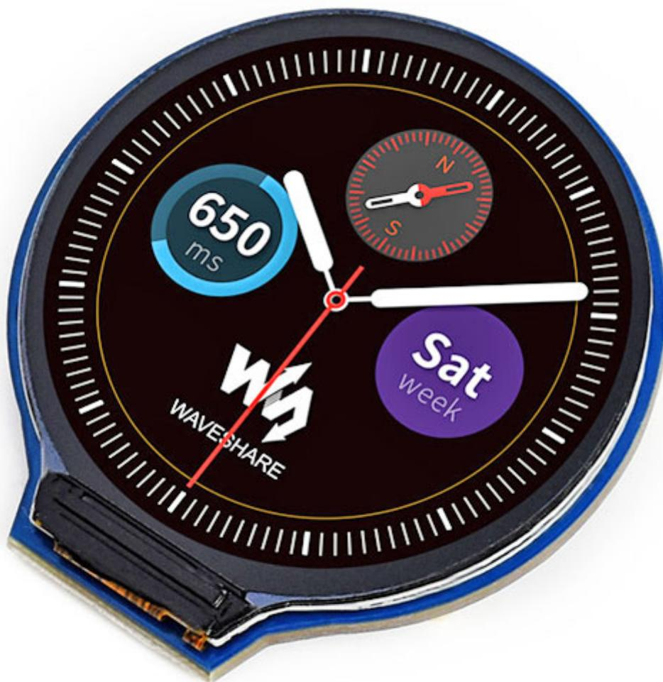
Originale display tondo a colori (RGB 65K) da 1,8". Dispone di una risoluzione di 240x240 pixel, driver GC9A01, interfaccia di comunicazione SPI a 4 fili e retroilluminazione. Sono disponibili esempi per Raspberry Pi, Arduino, STM32, ecc. Può essere utilizzato con Raspberry Pi, Jetson Nano, Arduino, STM32.
