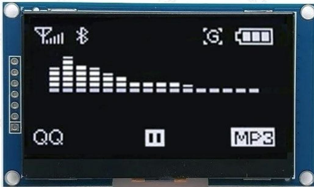
Modulo con display OLED (Organic Light Emitting Diode) da 2,42", 128x64 pixel, caratteri bianchi, interfaccia SPI / I<sup>2</sup>C (SPI di default, per I<sup>2</sup>C vedere tabella), controller grafico SSD1309, angolo di visione circa 80°. Dotato di un buon contrasto, non necessita di retroilluminazione. Alimentazione: 3,3 VDC, dimensioni (mm): 72x43x5,9, peso: 22 grammi, temperatura di lavoro: da -40°C a +85°C.
