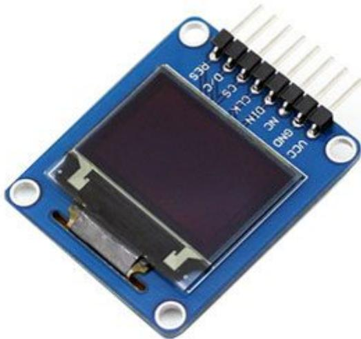
Display OLED RGB (Organic Light Emitting Diode) da 0,95". Dotato di un buon contrasto e colori brillanti, non necessita di retroilluminazione. Dispone di controller grafico SSD1331 della SOLOMON SYSTECH, interfaccia SPI, risoluzione: 96x64, dimensioni area attiva del display (mm): 19x12, dimensione scheda (mm): 37x32.
