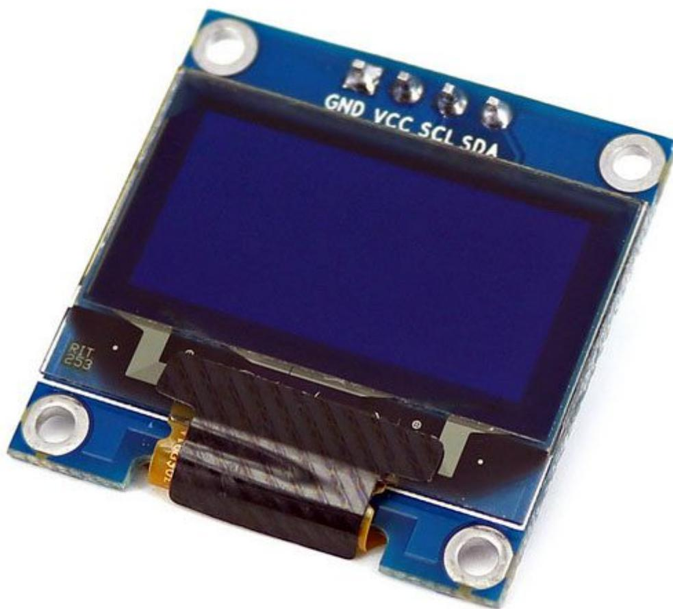
Modulo con display OLED (Organic Light Emitting Diode) 128x64 pixel di colore blu, interfaccia I<sup>2</sup>C, controller grafico SSD1306, angolo di visione circa 180° e interfacciabile ad Arduino. Dotato di un buon contrasto, non necessita di retroilluminazione. Alimentazione: 3,3 Vdc, dimensioni (mm): 28x27x5, peso: 3 grammi.
