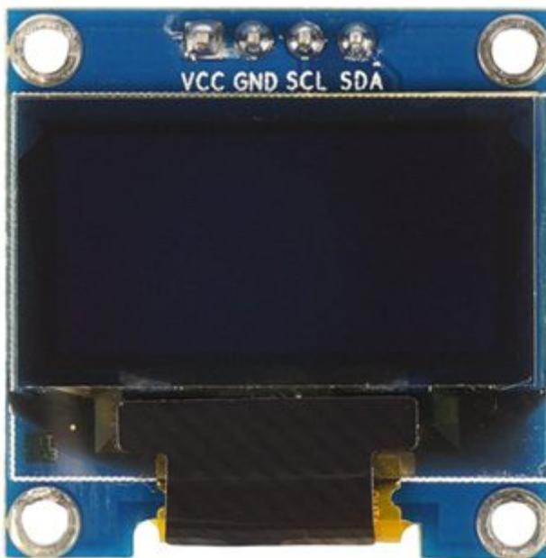
Modulo con display OLED (Organic Light Emitting Diode) 128x64 pixel di colore blu, interfaccia I<sup>2</sup>C, controller grafico SSD1306, angolo di visione circa 180°, compatibile con i pin della scheda Espresso Lite e interfacciabile ad Arduino. Dotato di un buon contrasto, non necessita di retroilluminazione. Alimentazione: 3,3 o 5 VDC, dimensioni (mm): 29,28x27,5x5, peso: 3 grammi. Pinout: VCC / GND / SCL / SDA
