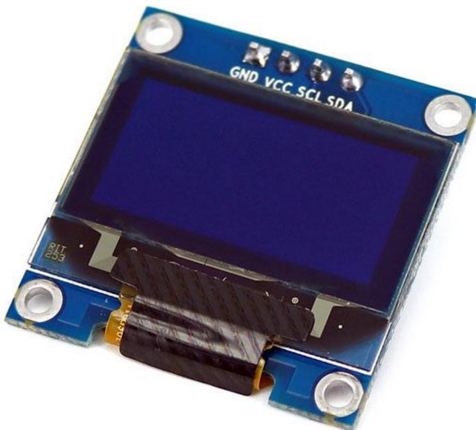
Modulo con display OLED (Organic Light Emitting Diode) 128x64 pixel di colore blu, interfaccia I<sup>2</sup>C, controller grafico SSD1306, angolo di visione circa 180° e interfacciabile ad Arduino. Dotato di un buon contrasto, non necessita di retroilluminazione. Alimentazione: 3,3 VDC, dimensioni (mm): 26x25x5, peso: 3 grammi.
