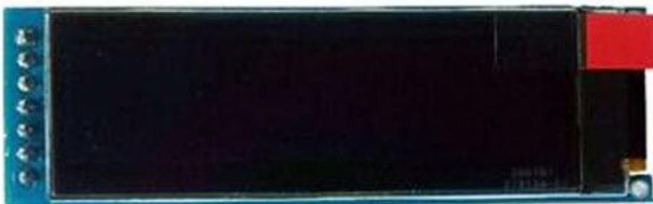
Modulo con display OLED (Organic Light Emitting Diode) da 2,08", 256x64 pixel, colore caratteri bianchi, interfaccia SPI, controller grafico SH1122, angolo di visione circa >160°, interfacciabile ad Arduino. Dotato di un buon contrasto, non necessita di retroilluminazione. Alimentazione: 3,3 VDC, dimensioni (mm): 70,5x22,5x5, peso: 10 grammi, temperatura di lavoro: da -40°C a +70°C.
