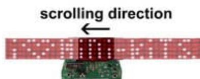
Create il vostro messaggio in movimento. 16 caratteri massimi. Velocità di scorrimento variabile. Premere "SET" per impostare un carattere. Premere i tasti "su" e giù" per selezionare i caratteri e terminare con il segno "<". Pausa display: premere "Stby".
