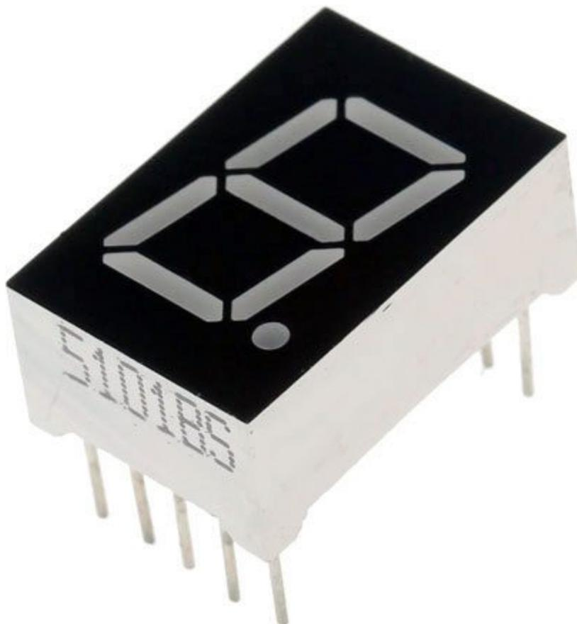
Display ad anodo comune 7 segmenti rossi. Altezza Digit 12,7 mm, tensione nominale: da 1,8 V, corrente: 15-20 mA, temperatura di lavoro: da -30°C a +85°C, dimensioni esterne (mm): 19x12,7x8.
