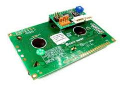
Display LCD seriale/I2C 4 righe a 20 caratteri con retroilluminazione verde e caratteri alfanumerici neri. Montata sul retro del display è presente una piccola scheda che riceve i dati CuNET (I2C) o seriali e li visualizza sul display. Può essere controllato direttamente utilizzando i comandi CUBLOC BASIC. Dimensioni: 98 x 60 mm.
