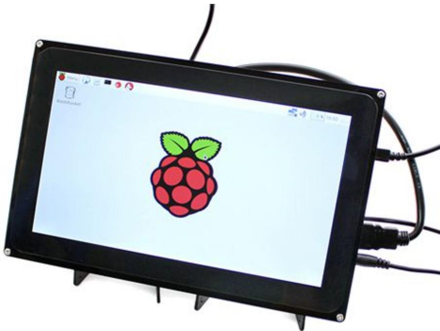
Display a colori touch da 10" con risoluzione di 1024x600 pixel. Particolarmente indicato per Raspberry Pi 3B e 3B+ / 2 / B + / A + / B (supporta Raspbian, Ubuntu, Windows 10 IoT) e Beagle Board black (con Angstrom image).
