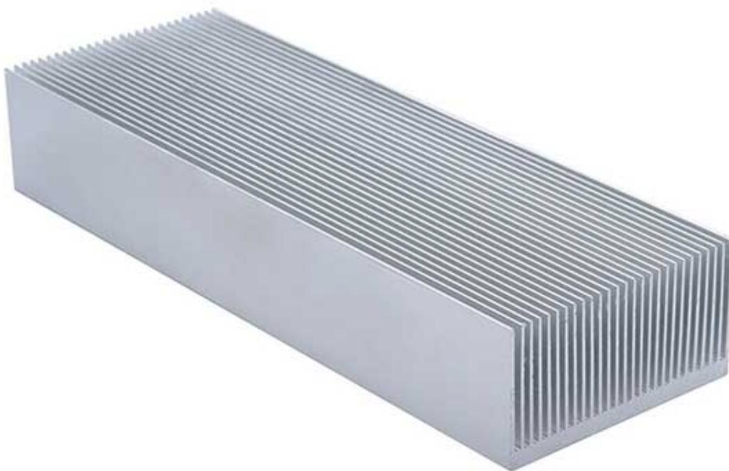
Dissipatore di calore in alluminio con dimensioni di 200x69x36 mm, dotato di 27 alette per aumentare l'area di contatto, migliorando così il trasferimento di calore e riducendo il rischio di surriscaldamento e guasti hardware.
