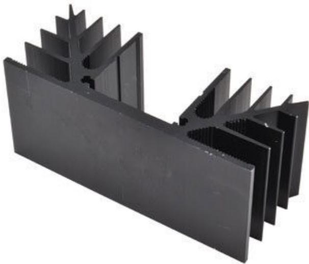
Dissipatore di calore per componenti con package TO3 e TO3PL con resistenza termica: 2,3°C/W. Dimensioni: 88 mm (larghezza) x 40 mm (altezza) x 35 mm (profondità).
