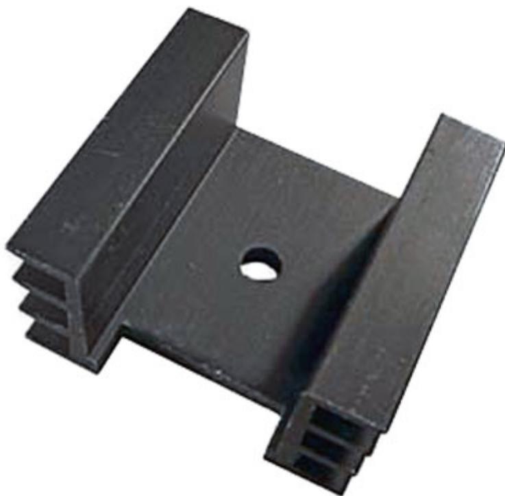
Dissipatore di calore per componenti con package TO-220, TO-218, TO-3P con resistenza termica: 9,5°C/W.
