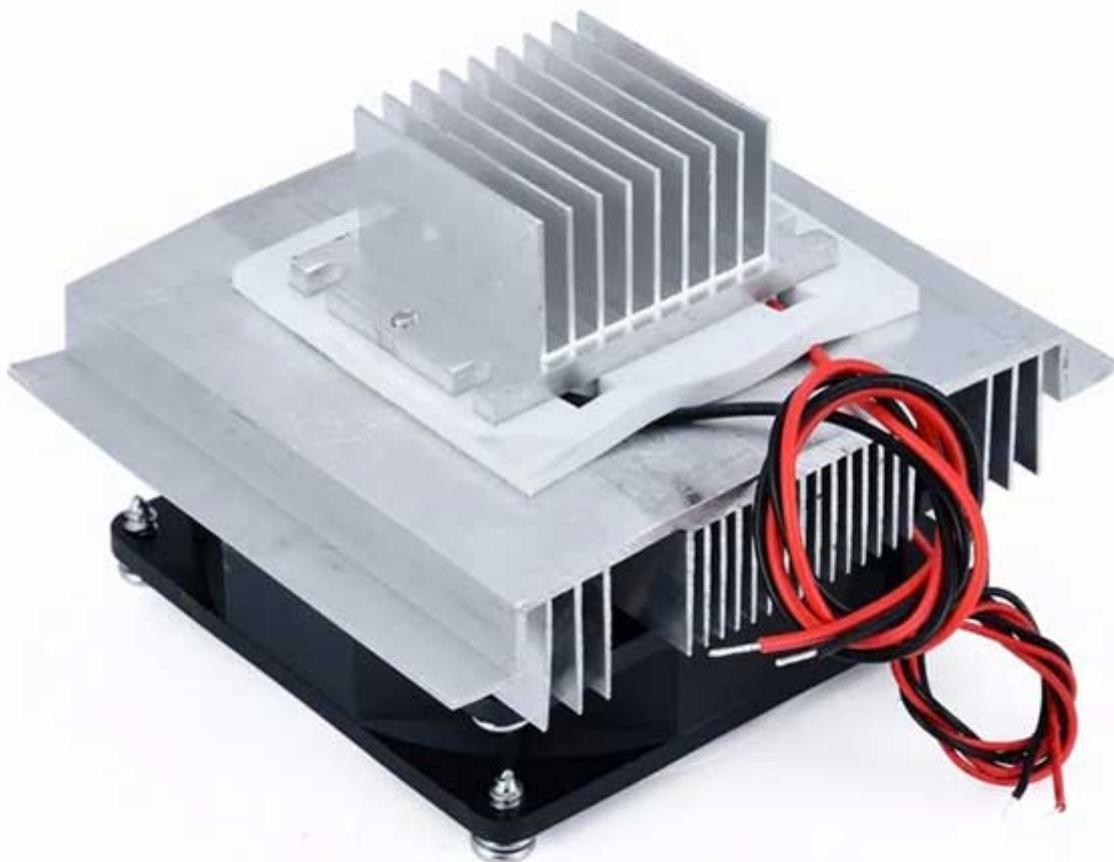
Composto da un dissipatore di calore in alluminio (100x118x24 mm), un dissipatore in alluminio (40x40x26 mm), un'isolante adesivo e una ventola 90x90 mm con alimentazione 12 VDC, consente di utilizzare in modo efficiente le celle di peltier con dimensioni 40x40 (circa 51 watt).
